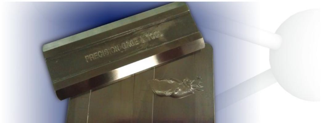
Die resultierende dünne Schicht oder Film auf dem Block wird dann visuell auf etwaige Klümpchen oder sonstige Auffälligkeiten untersucht. Alle visuellen Beobachtungen können auch mit Hilfe der Skala auf beiden Seiten entlang des Blocks gelesen werden. Die Skala kann in Hegmann-Einheiten (dimensionslos), Mikrometer oder 1/000 Zoll gelesen werden.
